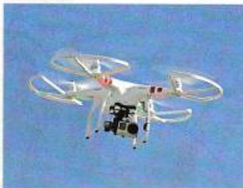
Un drone de type quadrirotor équipé d'une caméra vidéo.
